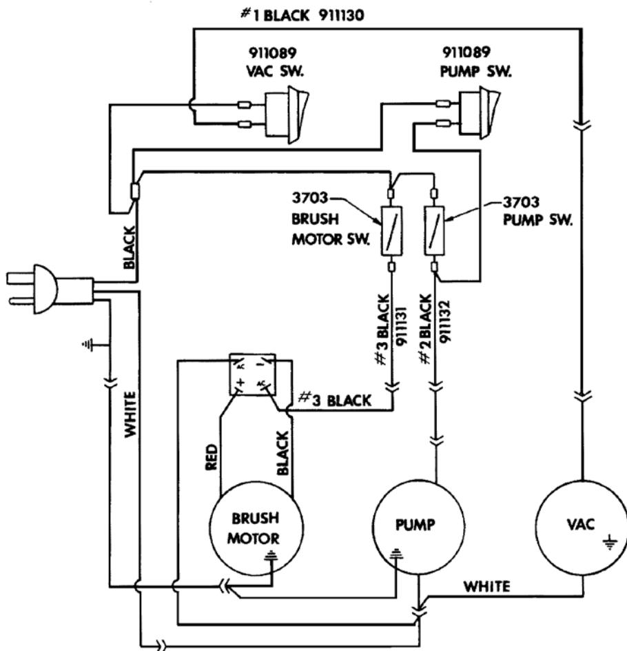
SCE-11 SELF CONTAINED EXTRACTOR - TANK & VACUUM MOTOR ASSEMBLY
